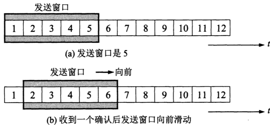
图 5-13 连续 ARQ 协议的工作原理
