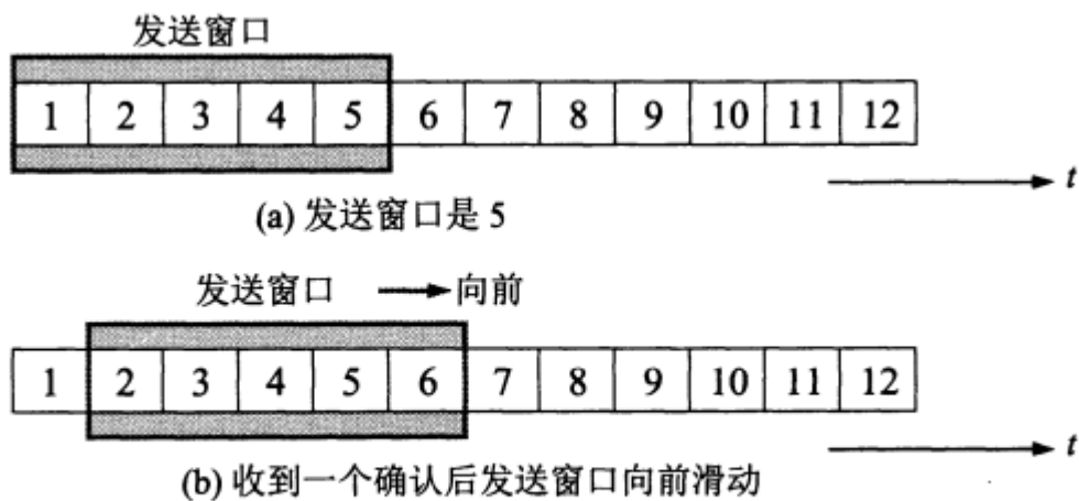
图 5-13 连续 ARQ 协议的工作原理
