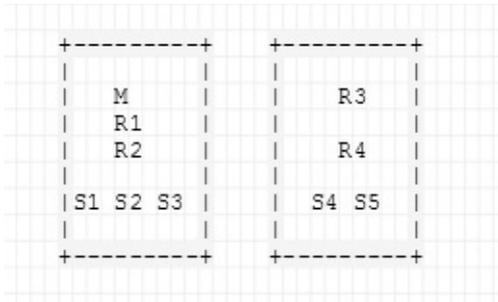
这个场景配置Quorum=3. 此时切断两台机器的通信网络（模拟两个机房之间通信中断），左边的机器（模拟主机房）集群不会受到影响，右边的机器（模拟灾备机房）由于不够大多数因此不会产生新的Master。
