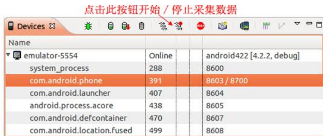
点击上图中所示按钮即可以采集目标进程的数据。当停止采集时，DDMS 会自动触发 Traceview 工具来浏览采集数据。
