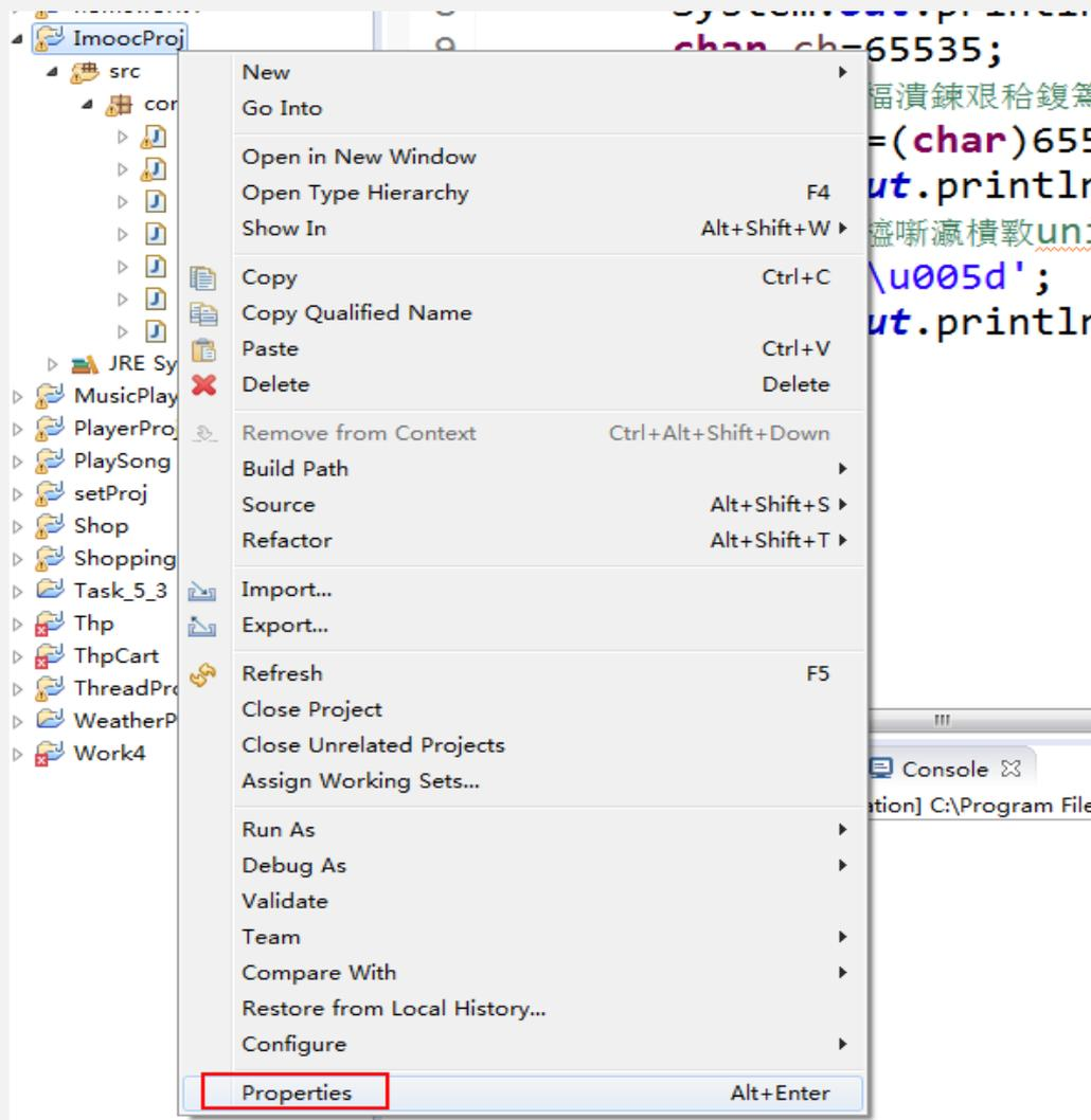
3) 在 Resource 项的右侧找到 Text file encoding , 默认选中的是 Inherited from container(GBK),我们选择 Other , 在右侧下拉列表中选择 UTF-8 , 然后点击右下方的 Apply,再点击 OK。就可以发现乱码问题解决了。
