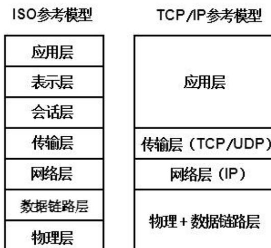
图 3-4 ISO 模型与 TCP/IP 模型的对应关系
